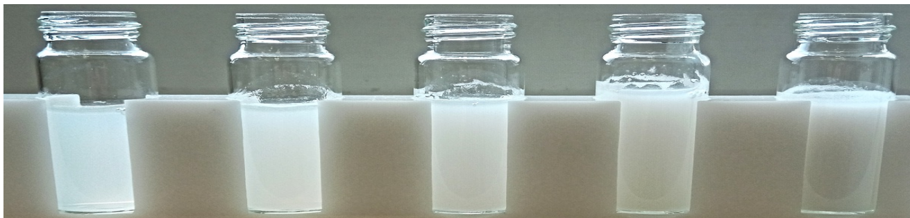
Фотографии наножидкостей с частицами оксида алюминия при различной концентрации слева направо: 0.125 wt. %, 0.25 wt. %, 0.5 wt. %, 1 wt. %, 2 wt. %.
